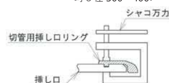
図 3.3.71 切管用挿しロリングの締め付け
