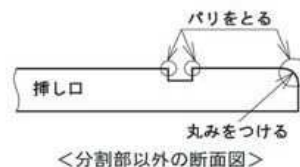
図 3.3.70 挿し口のバリ取りおよび端面処理
