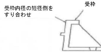
図 5.4.3 すり合わせ加工（急勾配受け構造）
