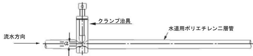
図 5.1.5 クランプ治具による断水
