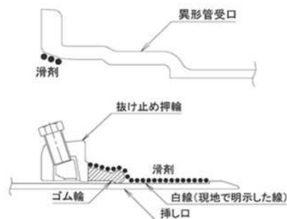
図 3.3.135 滑剤の塗布範囲（異形管部）
