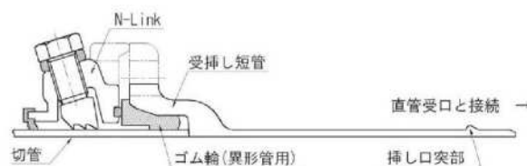
図 3.3.112 切管を直管に接合する場合
