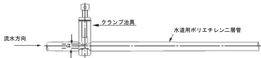
図 5.1.5 クランプ治具による断水
