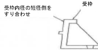
図 5.4.3 すり合わせ加工（急勾配受け構造）
