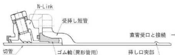
図 3.3.112 切管を直管に接合する場合
