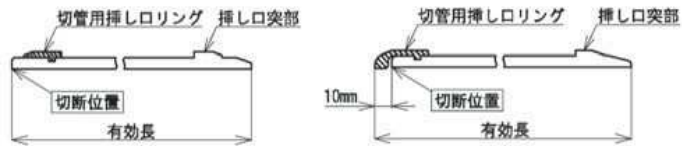
図 3.3.67 切断位置と有効長（乙切管の場合）
