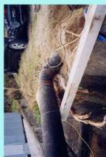
沼田東町釜山 鋼管φ200 継手 破損
